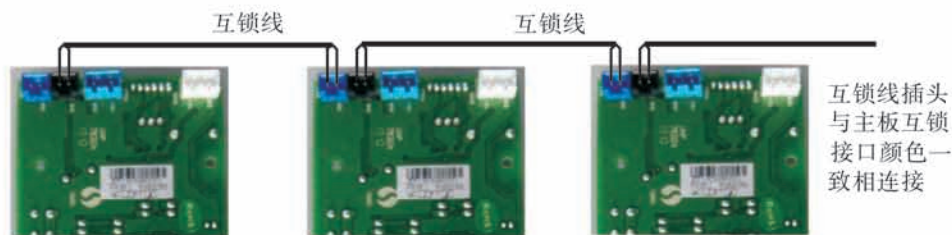
图3-9 互锁的接线图
